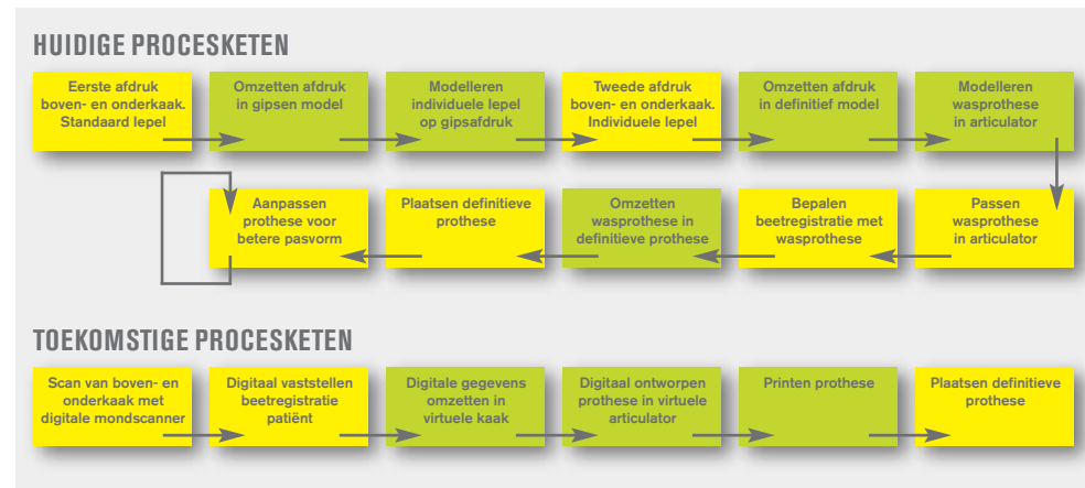
Deze figuur vergelijkt de huidige en gewenste procesflow voor het vervaardigen van prothesen. 3D-printen heeft als voordelen: minder handwerk, minder fouten (die in het huidige proces ontstaan door de vele omzettingen), eenvoudige reproductie en een kortere doorlooptijd. De gele stappen vinden plaats bij de tandarts, de groene bij het tandtechnisch laboratorium. Bron: Fieldlab Multi-materiaal 3D Printing Projectplan (2016).
